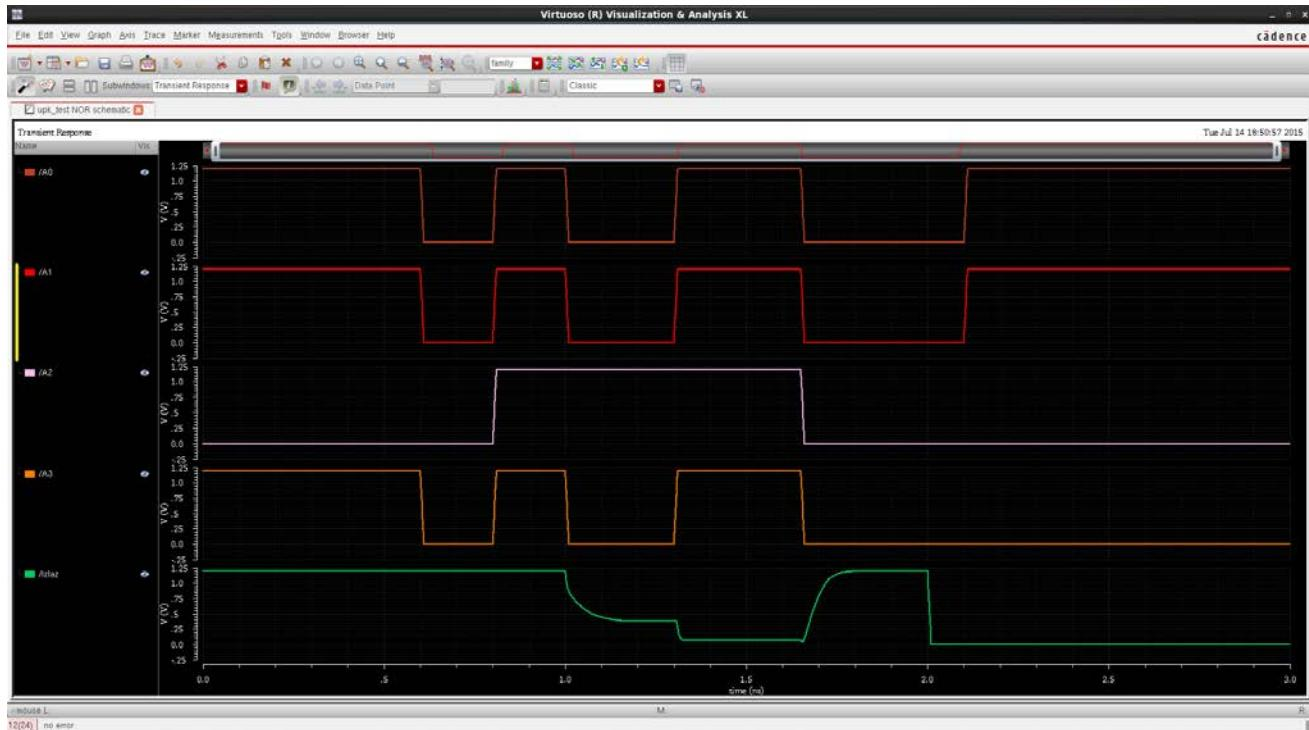
Takođe treba pomenuti da su izvori signala zapravo kao idealni naponski izvori sa 10 milioma rednom otpornošću, zbog toga se javljaju "smetnje" veličine nV (ne mogu se videti na grafiku). Ove otpornosti kao i otpornost viske impedanse je moguće podešavati, detaljnije u priloženom fajlu o vektor simulaciji.
